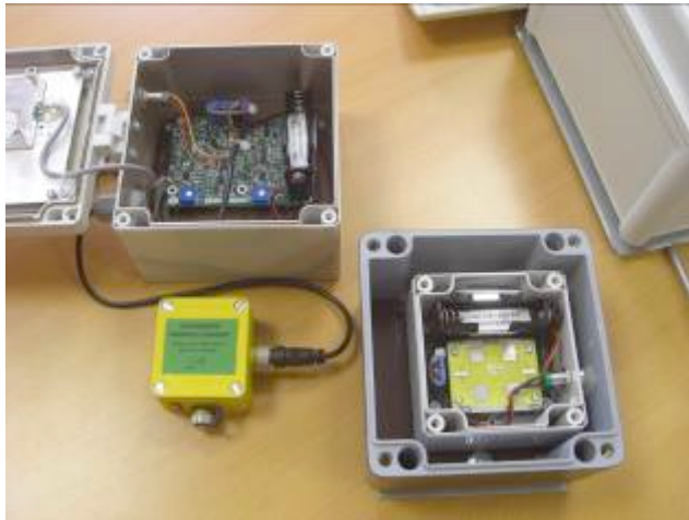
26. attēls. Atvērtais skaitītāja RBX5 L raidītājs, uztvērējs un datu glabātājs (dzeltenā krāsā)
