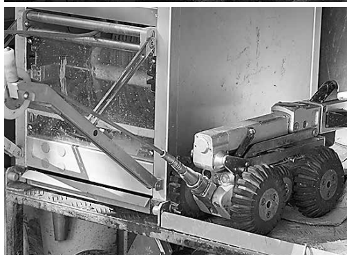
Inspekcijas robots ir viens, bet tas ir paredzēts vairākiem cauruļu diametriem.
